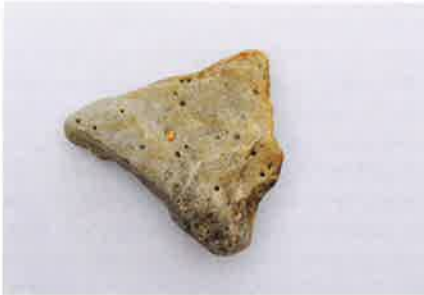
Figuur 21: Reviniaankwartsiet of pyrietkwartsiet (met kubische holten ontstaan na verwerking van de pyrietkristallen)
