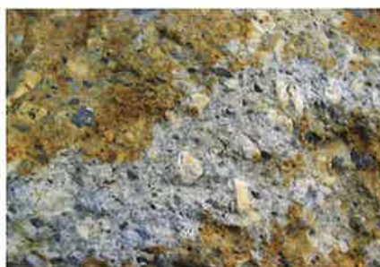
Figuur 33: Detailfoto van het ruwe oppervlak van een niet-verweerde granietporfier (crèmekleurige prismatische veldspaatkristallen en blauwachtige glazige kwarts kristallen)
