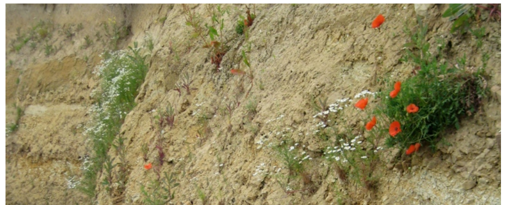
Tijdelijke ontsluiting van sterk verbrokkelde mergel en Tuffeau van Lincient, (onder een leemlaag), in een bouwput van het nieuwe woon- en leefcomplex van Triamant in Velm (foto 2011).FOTO ROLAND DREESEN
